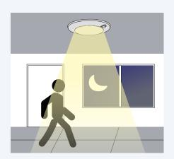
With insufficient daylight, when motion detected, light turns ON. Lorsque la lumière du jour est insuffisante et qu'un mouvement est détecté, la lumière S'ALLUME.
