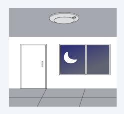
After the last detection and the present hold time has elapsed, light turns OFF. Après la dernière détection et lorsque le temps de rétention est écoulé, la lumière S'ÉTEINT.
