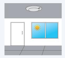
With sufficient daylight, even when motion detected, light remains OFF. Lorsque la lumière du jour est suffisante, même si un mouvement est détecté, la lumière reste ÉTEINTE.
